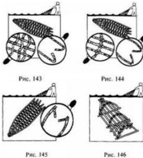
В случае, когда при сооружении верши не удастся связать кольца, образующие ее каркас, можно изготовить упрощенную версию верши нетрадиционной треугольной либо овальной формы. Для этого надо найти и срезать несколько одинаковых по толщине и виду раздвоенных на конце жердин (рогаток). Затем соединить расходящиеся концы «рогаток» и к полученным элементам поперечного каркаса привязать продольные жерди, которые затем переплести тонкими ветками (рис. 146).
